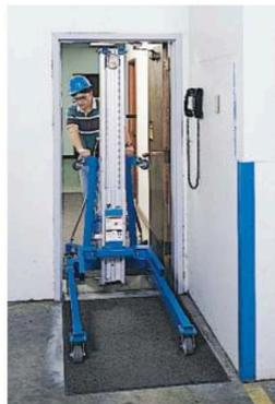
**Der SLA** kann aufrecht stehend durch Standardtüren geschoben werden und muss weder angekippt noch die Last entfernt werden
